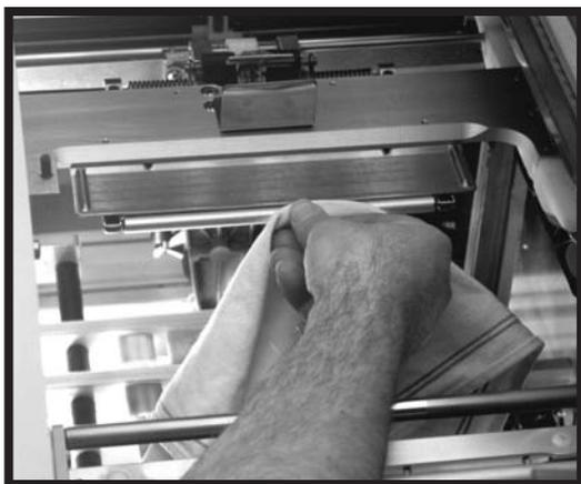
Nettoyer le dessus (A) des pincers d'étreinte avec un chiffon humide. Presser sur chacune (B) pour ouvrir et nettoyer le coussinet (C) avec un chiffon humide. Laisser sécher avant d'utiliser l'appareil.
