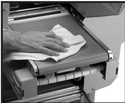
Nettoyer le rouleau de déroulement de la pellicule (A) avec un chiffon imbibé d'alcool (de préférence) ou d'eau chaude. Nettoyer le rouleau de caoutchouc (B) avec un chiffon humide. Enlever tous débris si nécessaire.
