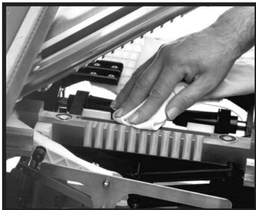
Enlever tous débris de pellicule dessous la pince centrale si nécessaire. Nettoyer celle-ci avec un chiffon propre imbibé d'alcool (de préférence) ou d'eau chaude. Bien assécher avant de faire fonctionner.
