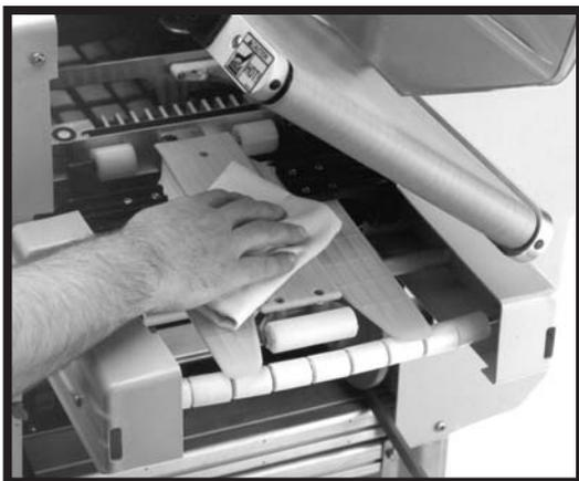
Alors que le convoyeur est en position levée, nettoyer la bande de caoutchouc du distributeur avec un chiffon humide. Pour abaisser le convoyeur, le tenir par la poignée et le descendre délicatement.
