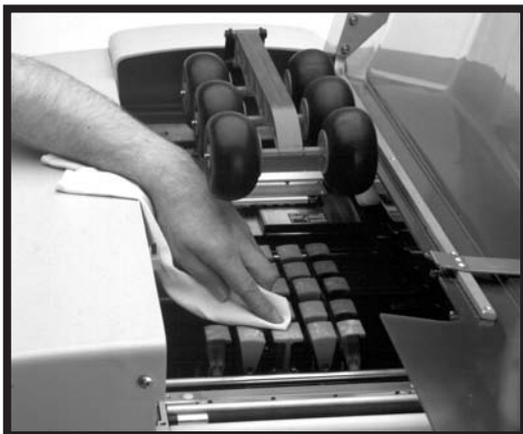
Nettoyer les courroies d'entrée ainsi que la porte avec un chiffon humide. Essuyer les courroies et rouleaux pour enlever toute graisse et débris.
