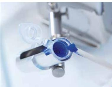
**ErgoClips et SmartGrid accélèrent le processus de pesage** garantissent des résultats fiables mais aussi souplesse et sécurité d'utilisation : ErgoClips pour peser tout type de récipient ; SmartSens permet d'ouvrir la balance sans toucher le pare-brise, ce qui empêche toute contamination ; SmartGrid accélère le pesage et facilite le nettoyage de la balance.
