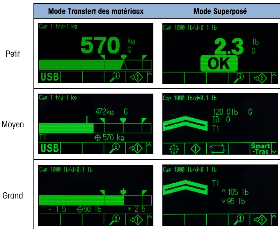
Figure 3-16 : Mode Dimensions d'affichage SmartTrac, Transfert de matériaux et Superposé
