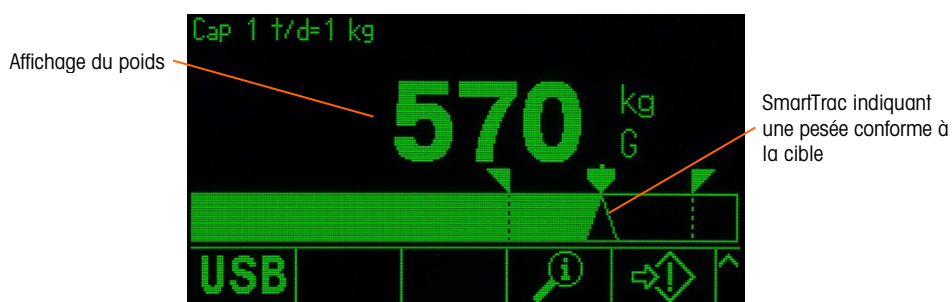
Figure 2-22 : Transfert de matériaux SmartTrac, petit
