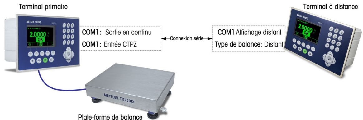
Figure 4-15 : Exemple de configuration série d'un terminal pour une fonction d'affichage distant
