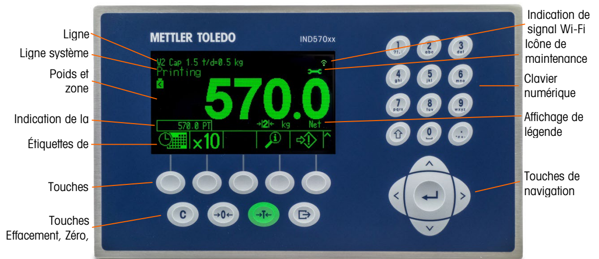
Figure 1-10 : Agencement du panneau avant de l'IND570
