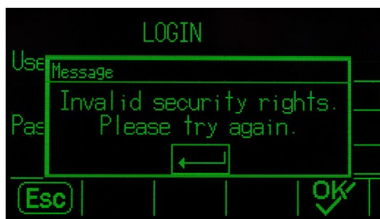
Figure 2-1 : Test de sécurité – Notification de droits non valides
